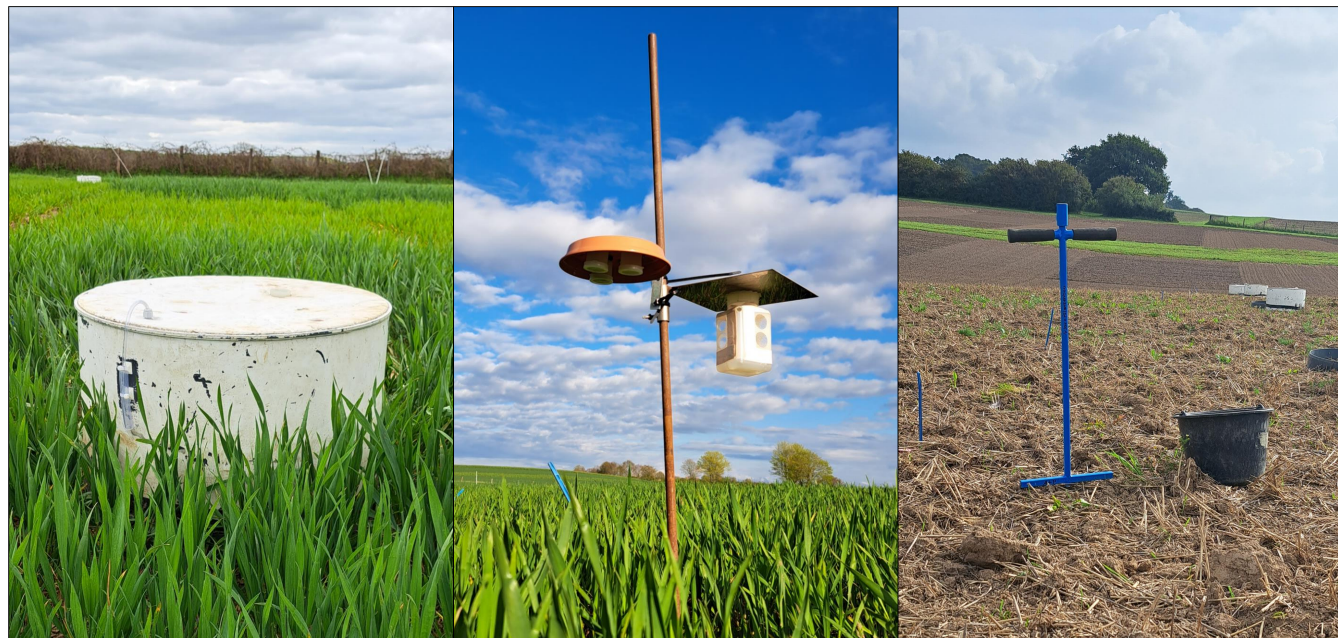
Abbildung 1: statische Messkammer im Weizenbestand; Messung der Ammoniak Emissionen mittels Säurefalle und Alphasampler; Bodenprobennahme bis 30 cm Tiefe (v.l.n.r.)
